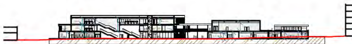
La graduation des échelles du bâti d'Ouest en Est optimise l'ensoleillement du projet.
